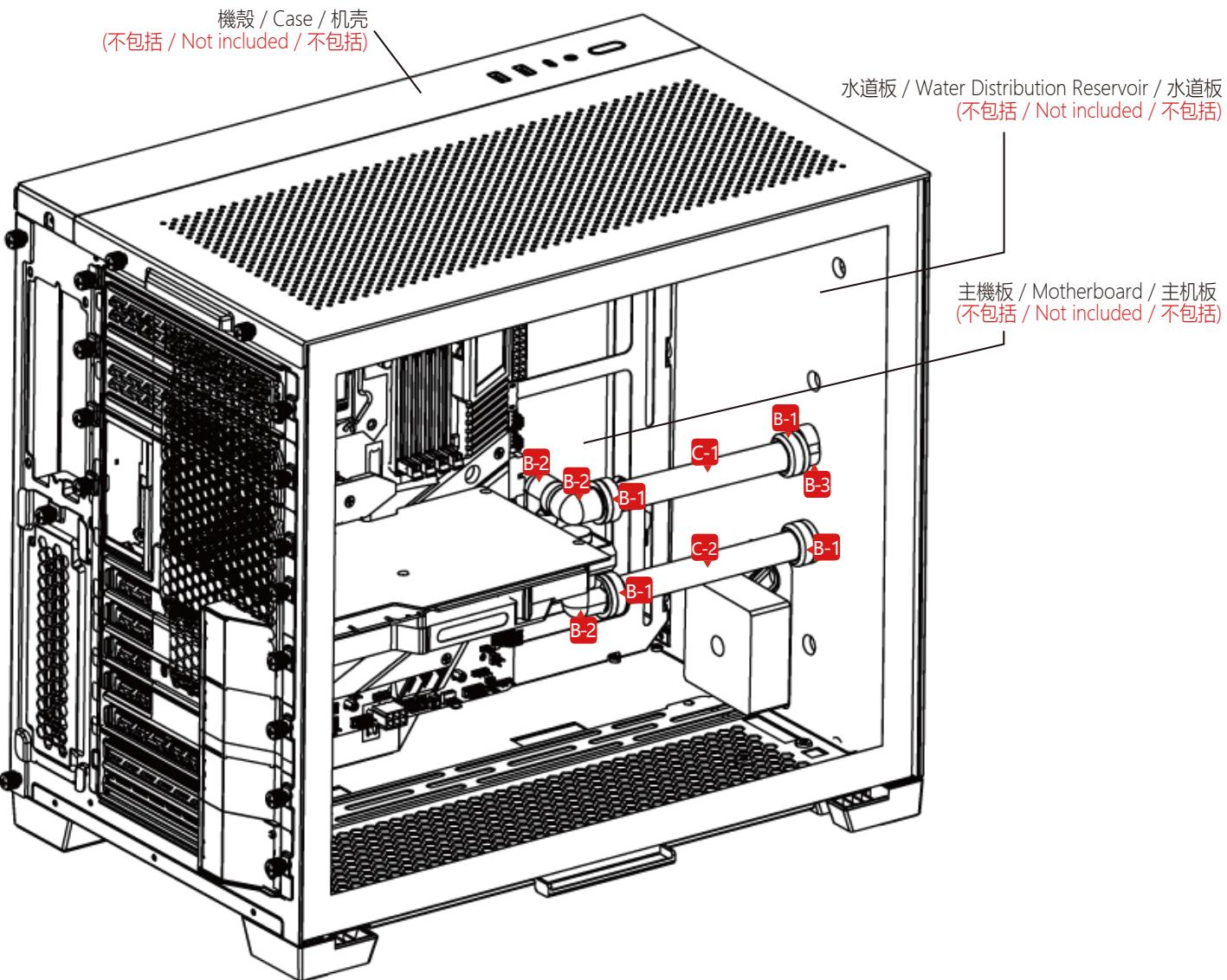
注意：跑水前，請先確認所有零件已安裝在正確的位置上，在不開主機，單開水泵的情況下，進行24小時的跑水測試，確保無漏水情況後再開主機，避免發生漏水而導致電腦零件的損壞。
