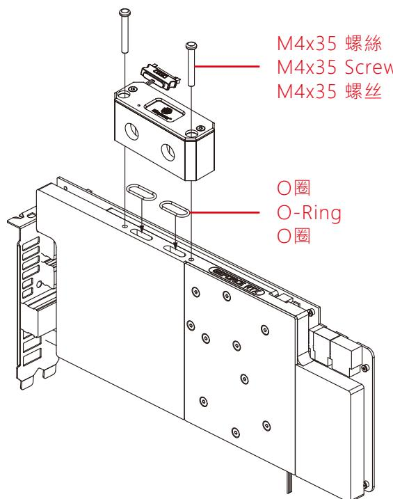
注意：跑水前，請先確認所有零件已安裝在正確的位置上，在不開主機，單開水泵的情況下，進行24小時的跑水測試，確保無漏水情況後再開主機，避免發生漏水而導致電腦零件的損壞。
