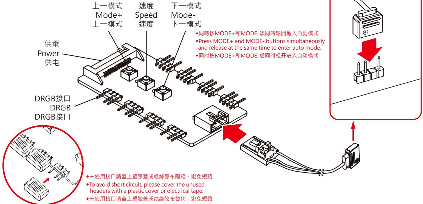
此DRGB控制器作用是擴展主板上不足的RGB接口，一個DRGB接口可分出八個，用於統一控制多個支援主板燈效的風扇和燈條等設備；同時，控制器具備自有的燈光效果，可透過控制器上的按鍵來切換。
