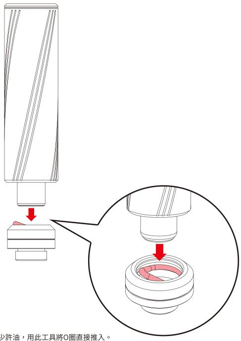
使用前確認工具前端沾有少許油,用此工具將O圈直接推入。
