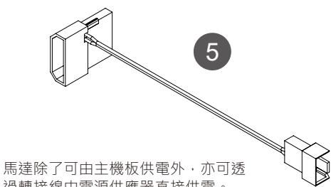
馬達除了可由主機板供電外，亦可透過轉接線由電源供應器直接供電。
