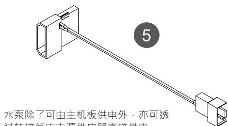
水泵除了可由主机板供电外，亦可透过转接线由电源供应器直接供电。
