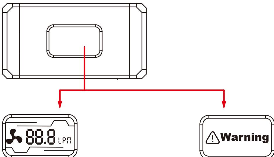
產品工作界面，葉輪帶動畫效果，顯示流量量程為0.1~30.0LPM，精度±5%，當流量低於10.0LPM時，不顯示十位數。
