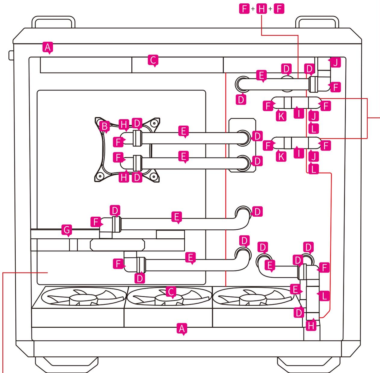
三個散熱器安裝方式, 推薦使用 m-ATX 主板。
