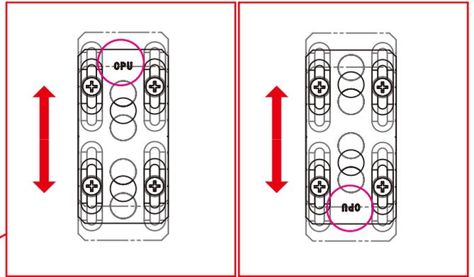
※ 可通过调整孔位偏移块的位置，以对应不同主机板的 CPU 安装位置。
