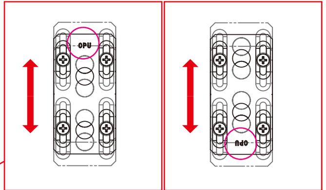
※ 可通過調整孔位偏移塊的位置，以對應不同主機板的 CPU 安裝位置。
