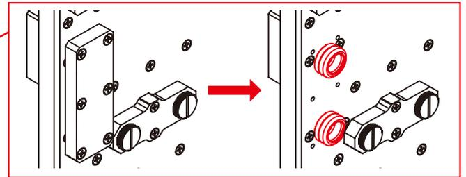
※ 安裝 GPU 冷頭時，需要把水路導通模組拆除，然後安裝相應的接頭即可使用。
