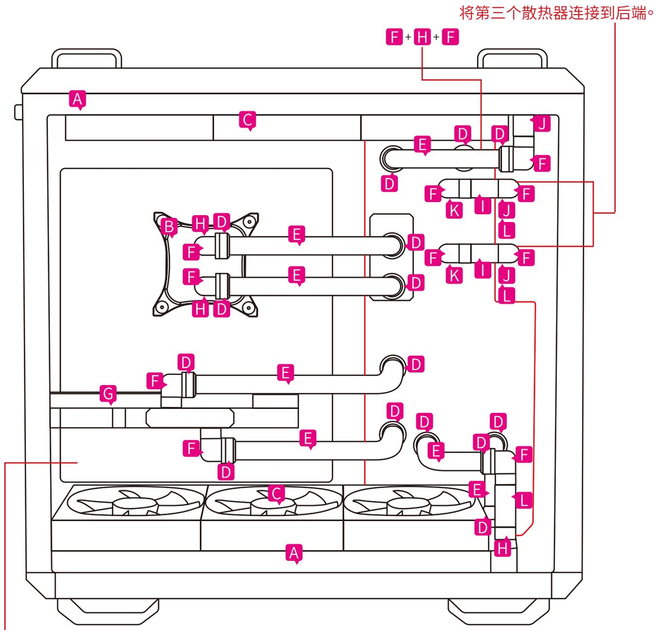
三个散热器安装方式, 推荐使用 m-ATX 主板。
